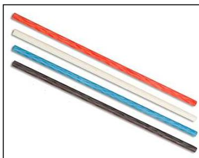
Pietra abrasiva a sezione tonda Fiber Stone costituita da fibre ceramiche incrociate. Ideale per lucidatura, manuale o con utensile rotante, di superfici di varie forme di acciai con durezza fino a 57 HRC, alluminio, rame, ecc.
