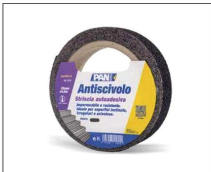
Nastro autoadesivo antiscivolo impermeabile e resistente a qualsiasi condizione meteorologica, all'abrasione, ad un livello di traffico estremo. Adatto per superfici lisce, inclinate, irregolari e scivolose. Supporto in accoppiato di corindone, grana in sabbia di cristallo, adesivo in acrilico modificato.
