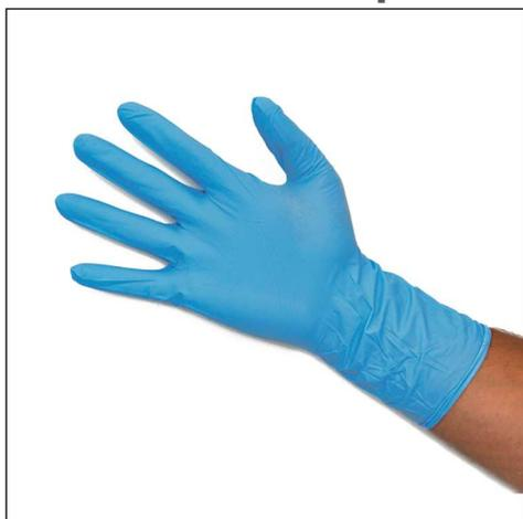
Guanto monouso in nitrile clorinato (non talcato) a spessore maggiorato per una protezione superiore, AQL 1,5. Dispositivo medico di classe I non sterile secondo Direttiva 93/42 CE s.m.i. 0465; dispositivo di protezione individuale categoria di rischio III secondo la Direttiva 89/686 CE; ad uso esclusivo per contatto breve (<30 min) con tutte le sostanze acquose (pH>4,5), alcoliche o grasse, conservate a temperatura ambiente e/o refrigerate (<40°C).
