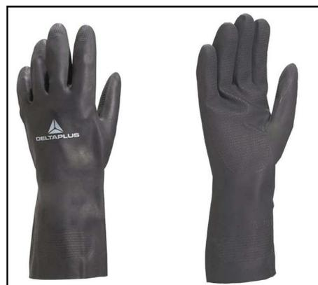
Guanto Toutravo 509 impregnato in neoprene con manichetta. Floccatura interna in cotone, rilievi sul palmo e sulle dita per una presa antiscivolo sia sull'asciutto che sul bagnato, impermeabile. Guanto di protezione meccanica per uso generale a norma EN388, resistenza all'abrasione; guanto per la protezione chimica a norma EN374-3 e dai microrganismi a norma EN374-2. Lunghezza cm 30, spessore mm 0,75. Colore nero. In confezioni da 12 paia.
