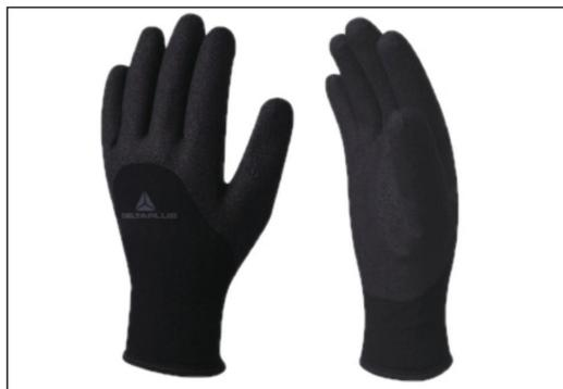
Guanto HERCULE VV750 in maglia a filo continuo: esterno 100% poliammide con finezza 13, interno 100% acrilico felpato con finezza 7, spalmato in spugna di nitrile (NBR) sul palmo, dita e semidorso. Flessibile, duraturo, protezione contro il freddo e l'acqua: fa scivolare i liquidi e permette una presa solida. Guanto di protezione meccanica e contro il freddo per uso generale. Colore nero, confezioni da 12 paia.
