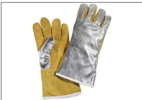
Guanto per saldatura e fonderia SCTKA, a norma EN 388:2016 4243X e EN 407:2004 423444. Palmo in crosta termica e dorso alluminizzato, foderato in maglia di lana; manichetta foderata in cotone ignifugo. Massima resistenza contro calore radiante e spruzzi di metallo fuso, ottimo grip, ideale per fonderia.
